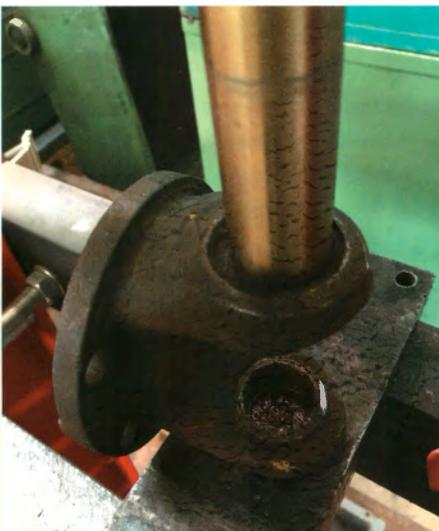
▲ Mit einer hydraulischen Presse und einem Dorn werden die alten Lager herausgedrückt.
