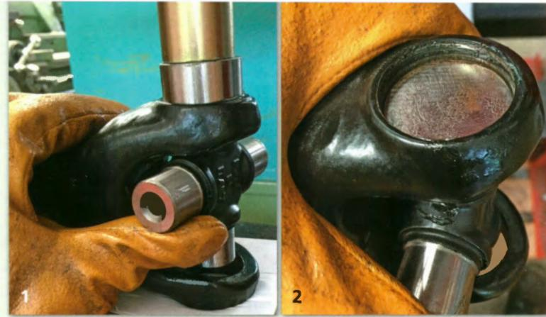
Nadeln in der Lagerschale nicht herausfallen und kein Schmutz ins Innere der Lagerschale gelangt. Das Kreuz muss gründlich entfettet werden. Das kann man in zwei Schritten durchführen: zunächst eine grobe Reinigung mittels Benzin und anschließend die Feinreinigung mittels Waschverdünnung. Zum Schutz des Schmiernippelgewindes empfiehlt es sich, den Schmiernippel gleich einzudrehen.
