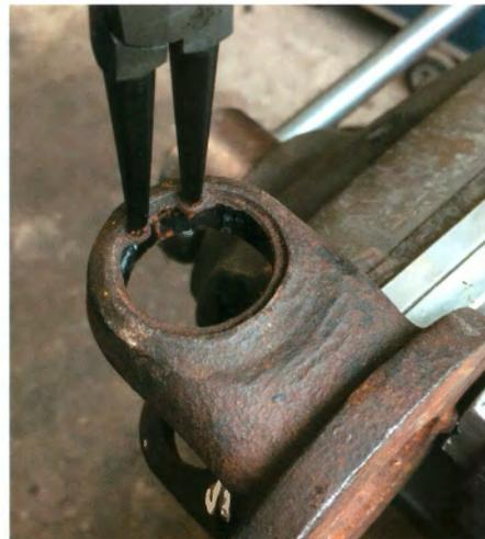
▲ Die alten Sicherungsringe werden demontiert.
