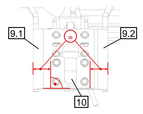
Die Anhängerkupplung [10] muss mittig und rechtwinklig zu den Wangen [9.x] ausgerichtet sein. Die Ausrichtung ist unabhängig von der Kupplungshöhe.
