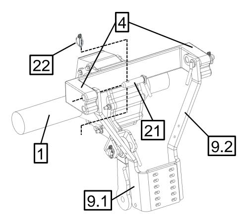
Das Innere der Bohrungen in der Wange [9.x] kann Lackreste aufweisen. Je nach Toleranzen der Bohrungen und des Bolzens [21] kann es sein, dass sich der Bolzen nicht oder nur sehr schwer in die Bohrungen einführen lässt. Sollte das der Fall sein, entfernen Sie die Lackreste im Innern der Bohrung mit etwas Schmirgelpapier, bis sich der Bolzen leicht einführen lässt.
