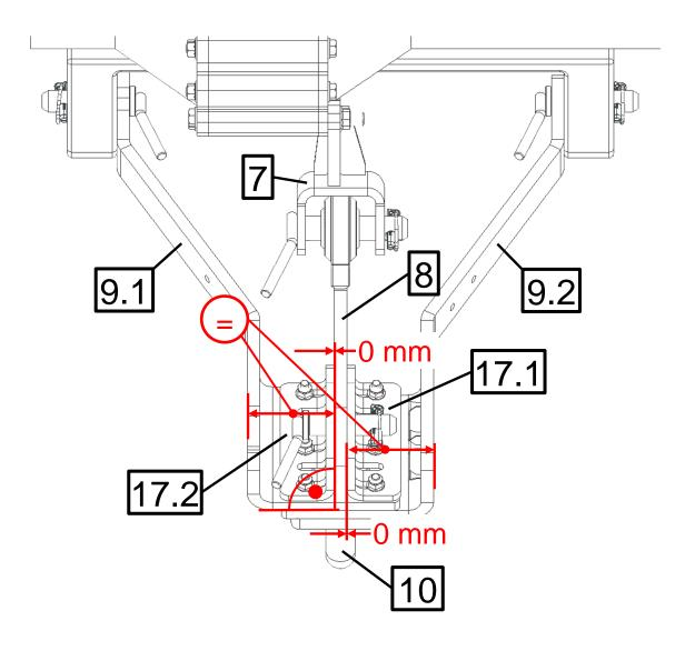
Zwischen den beiden Längsstrebenhaltern [17.x] und der Längsstrebe [8] muss der Abstand zwischen 0 und maximal 0,2 mm liegen. Alle drei Bauteile müssen rechtwinklig zu den Wangen der Anhängevorrichtung [9.x] angeordnet sein. Die Längsstrebe [8] muss in der Mitte zwischen beiden Wangen [9.x] liegen.
