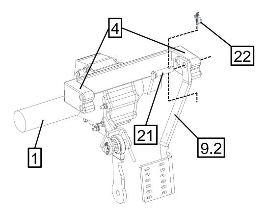
Das Innere der Bohrungen in der Wange [9.x] kann Lackreste aufweisen. Je nach Toleranzen der Bohrungen und des Bolzens [21] kann es sein, dass sich der Bolzen nicht oder nur sehr schwer in die Bohrungen einführen lässt. Sollte das der Fall sein, entfernen Sie die Lackreste im Innern der Bohrung mit etwas Schmirgelpapier, bis sich der Bolzen leicht einführen lässt.
