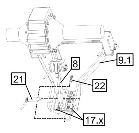
Das Innere der Bohrungen in der Längsstrebe [8] und den beiden Längsstrebenhaltern [17.x] ist beschichtet. Je nach Toleranzen der Bohrungen und des Bolzens [21] kann es sein, dass sich der Bolzen nicht oder nur sehr schwer in die Bohrungen einführen lässt. Sollte das der Fall sein, entfernen Sie die Lackschicht im Innern der Bohrungen mit etwas Schmirgelpapier, bis sich der Bolzen leicht einführen lässt.
