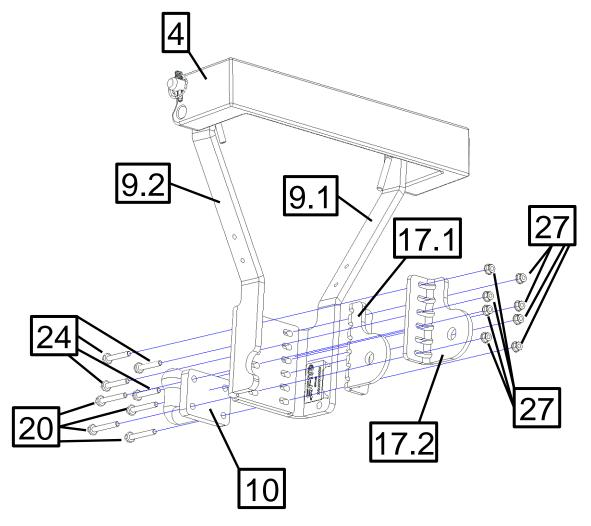
Die Anhängerkupplung [10] wird auf die im Arbeitsschritt (11) bestimmte Kupplungshöhe montiert. Die Abbildung zeigt exemplarisch die Kupplungshöhe H1.
