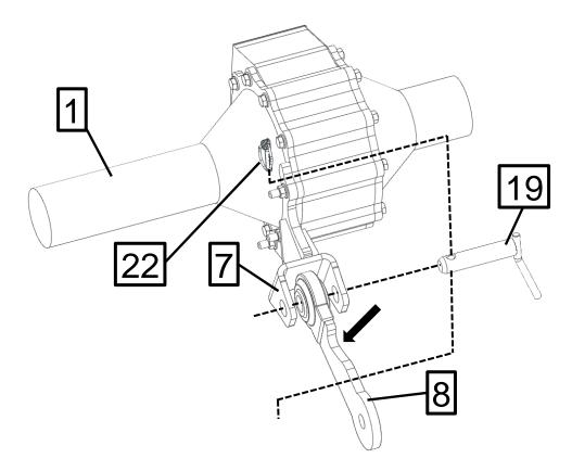
Das Innere der Bohrungen im Differentialhalter [7] ist beschichtet. Je nach Toleranzen der Bohrungen und des Bolzens [19] kann es sein, dass sich der Bolzen nicht oder nur sehr schwer in die Bohrungen einführen lässt. Sollte das der Fall sein, entfernen Sie die Lackschicht im Innern der Bohrungen mit etwas Schmirgelpapier, bis sich der Bolzen leicht einführen lässt.
