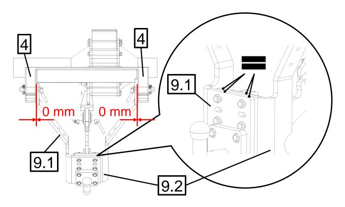
Zwischen den beiden Wangen der Anhängevorrichtung [9.x] und den beiden Anbauböcken [4] darf beidseitig kein Abstand sein. Da sich die Anbauböcke [4] nicht verstellen lassen, wurden die beiden Wangen [9.x] so ausgebildet, dass sie sich zueinander verschieben lassen. Damit ist eine Einstellung auf die Anbauböcke möglich. Die Wangen [9.x] sind so auszurichten, dass sie nach links und rechts spielfrei am Fahrzeug befestigt sind.
