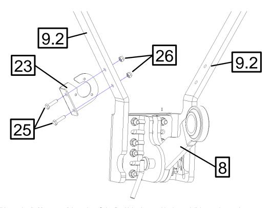
Die Abbildung zeigt die Montage auf der rechten Seite. Der Halter kann wahlweise auch links montiert werden.
